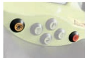
Commandes extérieures de la prise de force arrière déportées sur les deux ailes
