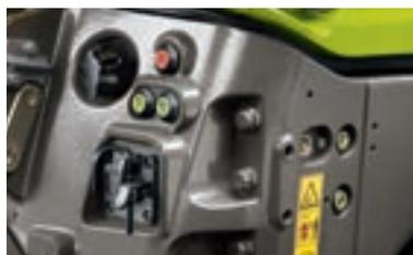
Commande extérieure du relevage avant et d'un distributeur sur la version CEBIS
