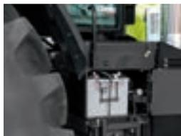
Accès optimal à la batterie à droite du marchepied d'accès à la cabine.
