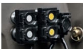
Jusqu'à quatre coupleurs hydrauliques et un retour libre sont disponibles à l'avant avec le relevage avant. Un équipement idéal pour une trémie ou une lame montée sur le relevage avant.
