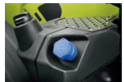
Réservoir de carburant de 455 l avec réservoir d'urée intégré de 42 l
