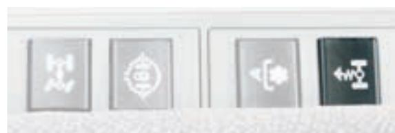
Activation de la suspension du pont avant
