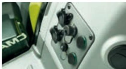
Les connexions pour l'alimentation des circuits électriques et les liaisons ISOBUS pour les terminaux additionnels sont regroupées sous la console de droite.
