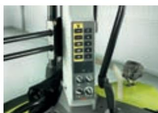
Présélection des régimes de prise de force et relevage arrière installés sur le montant arrière droit de la cabine
